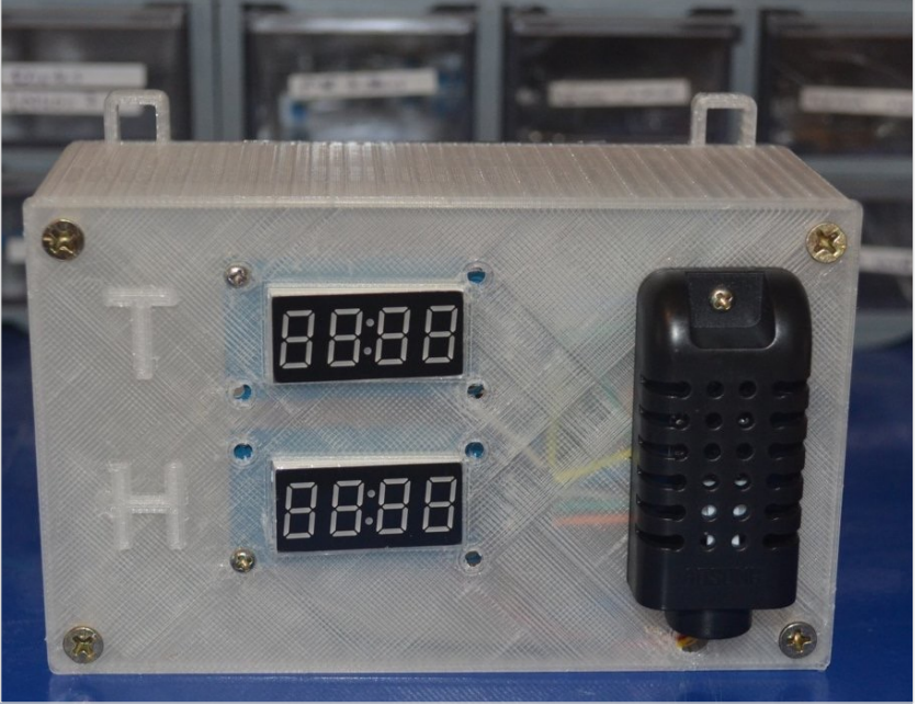
علبة لأحد المشاريع التي كنت أعمل عليها من أجل عرض درجة الحرارة والرطوبة
